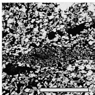
mylonite (scale bar : 2mm)
